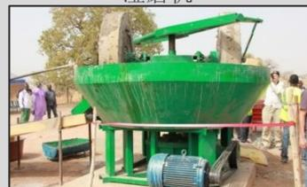
经过湿磨机和流矿槽的筛分后，接着进行淘金毯清洗和淘洗
