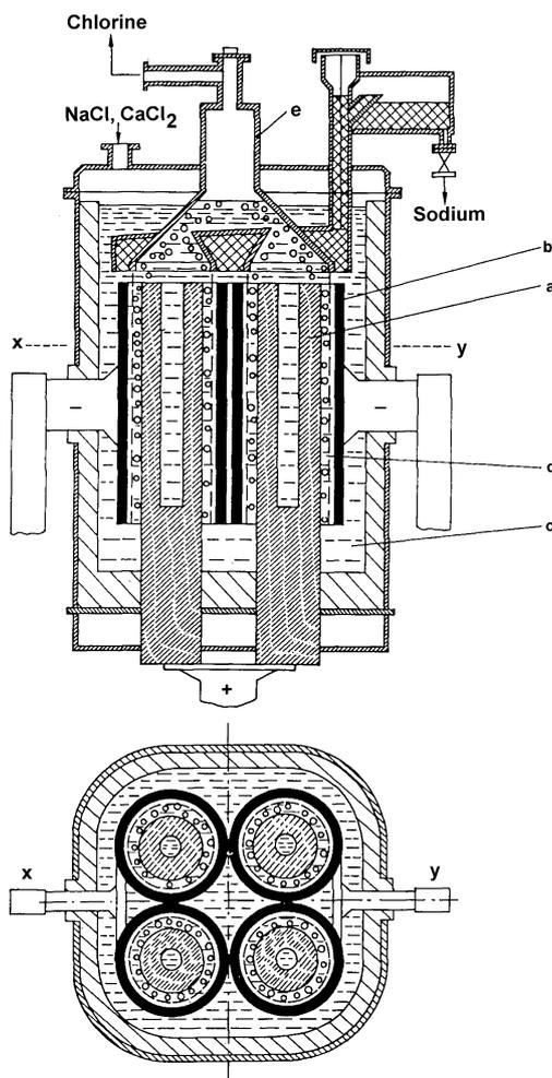
a) Anode; b) Cathode; c) Molten salt; d) Diaphragm; e) Chlorine dome
